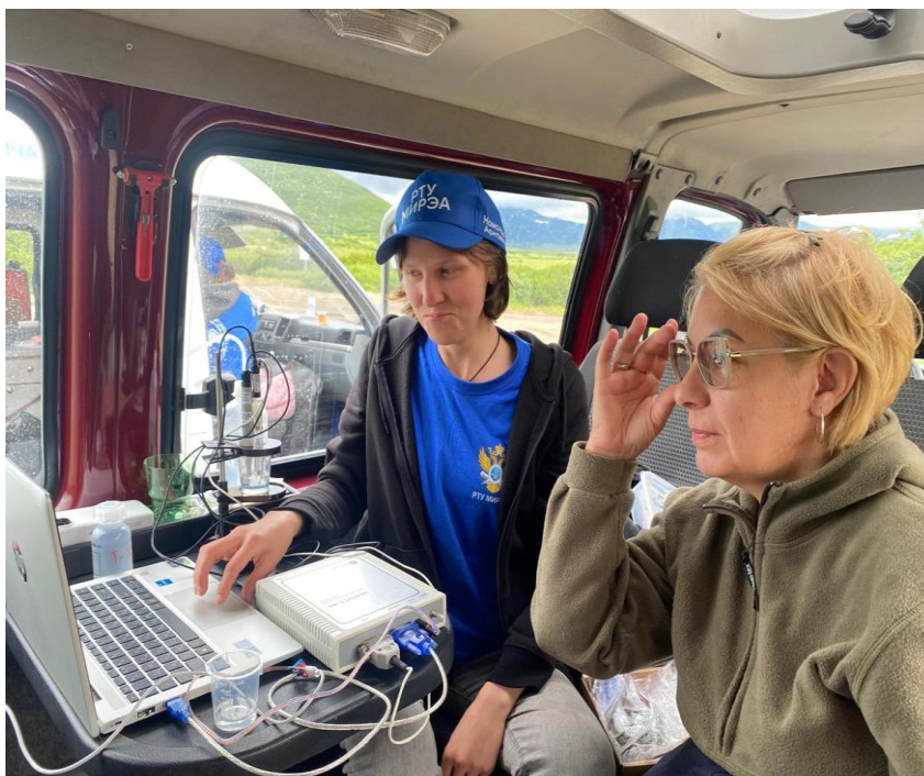
Измерение тяжелых металлов на портативном анализаторе «Экотест» в полевых условиях
