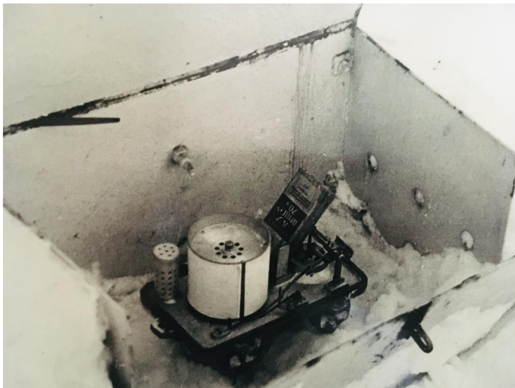
Рис. 2 «Гидростатический регистратор цунами ГР-23-II»
