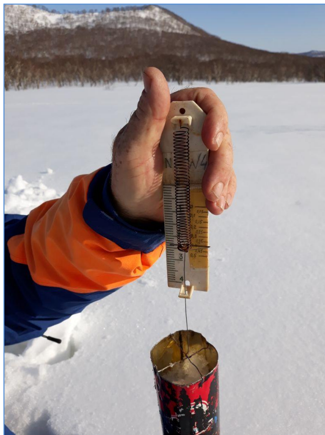
Измерение плотности снега специалистом КРПЛЦ
