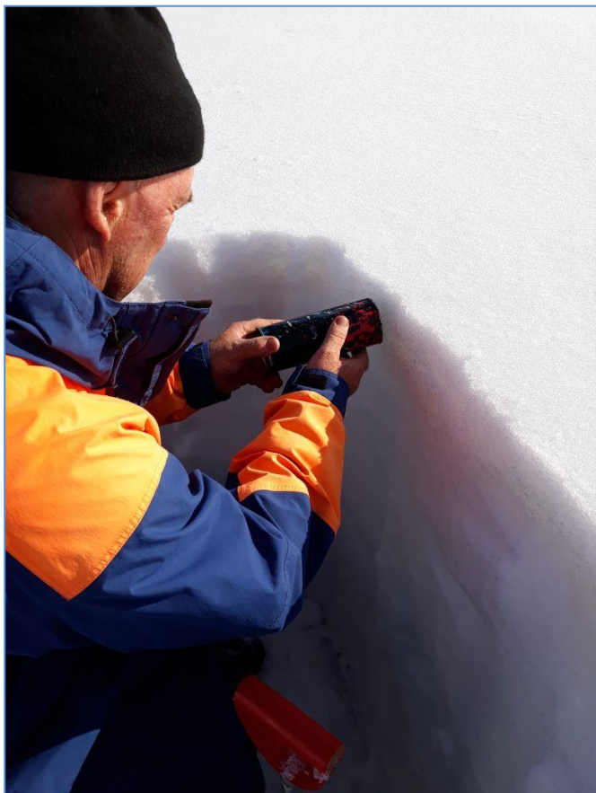
Измерение плотности снега специалистом КРПЛЦ
