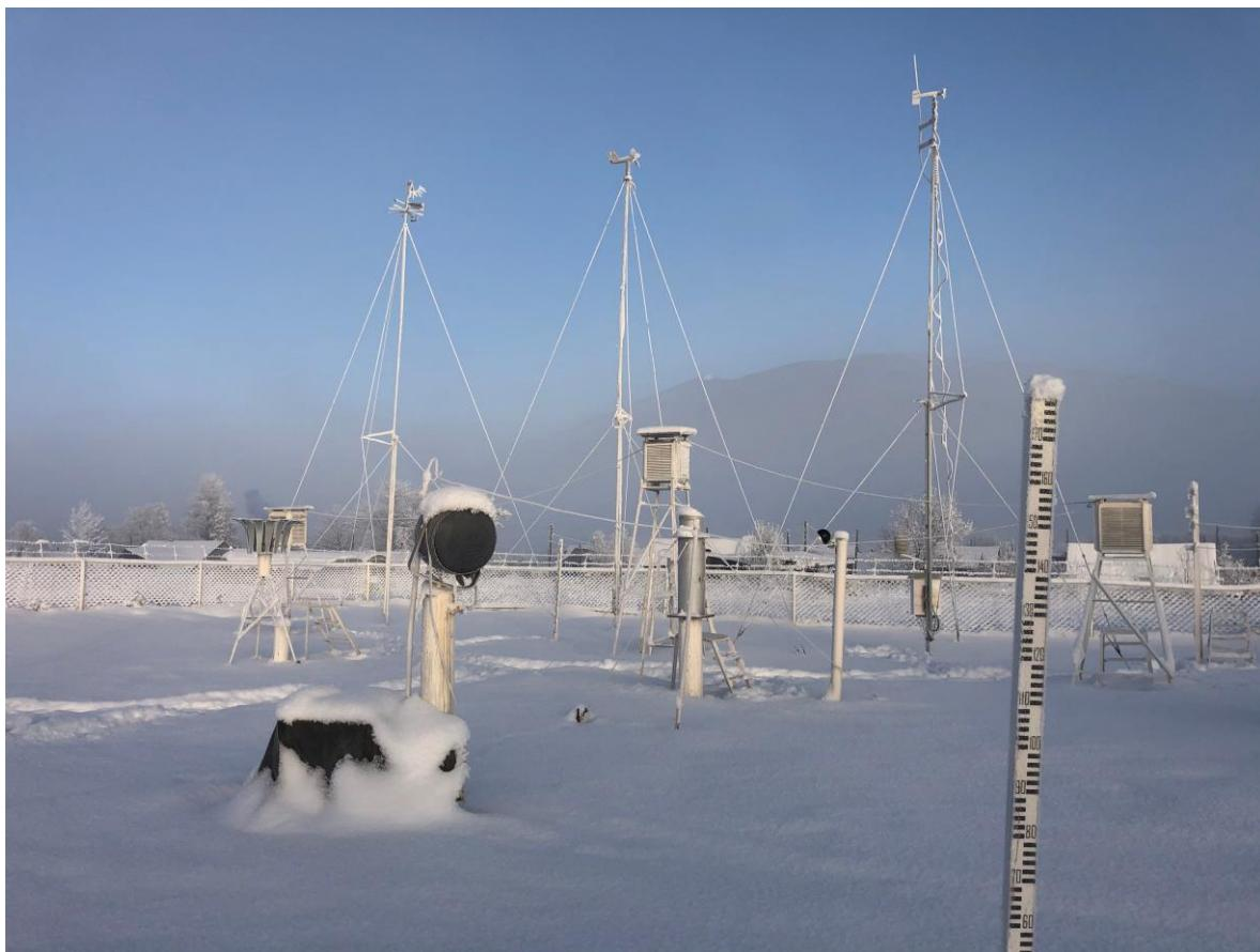
В метеорологии различают высоту снежного покрова и количество выпавших осадков. Высоту измеряют снегомерными рейками в сантиметрах. Для измерения количества осадков применяется осадкомер Третьякова, с приемной поверхностью 200 см<sup>2</sup>.
