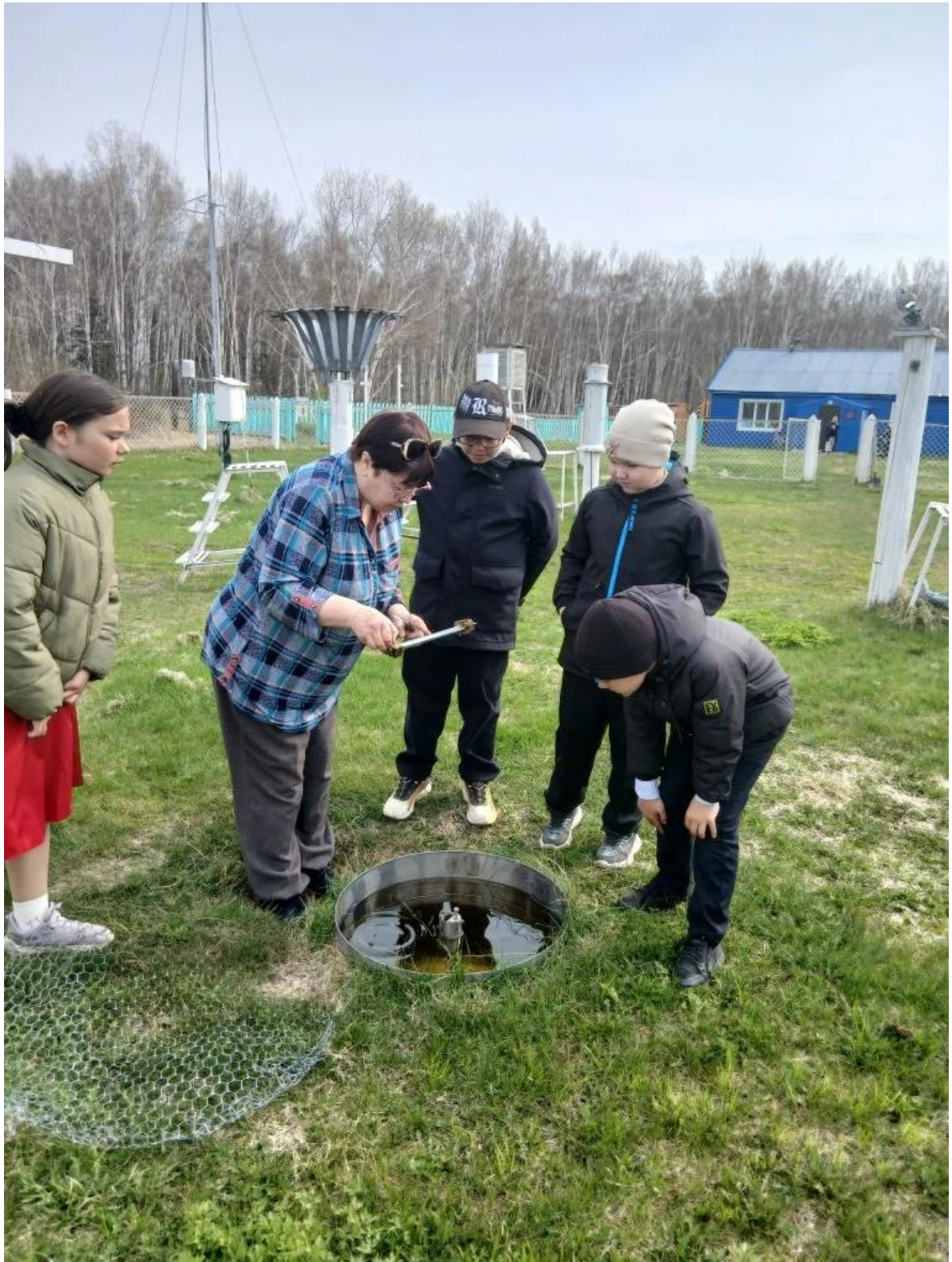
Производство наблюдений за испарением с водной поверхности
