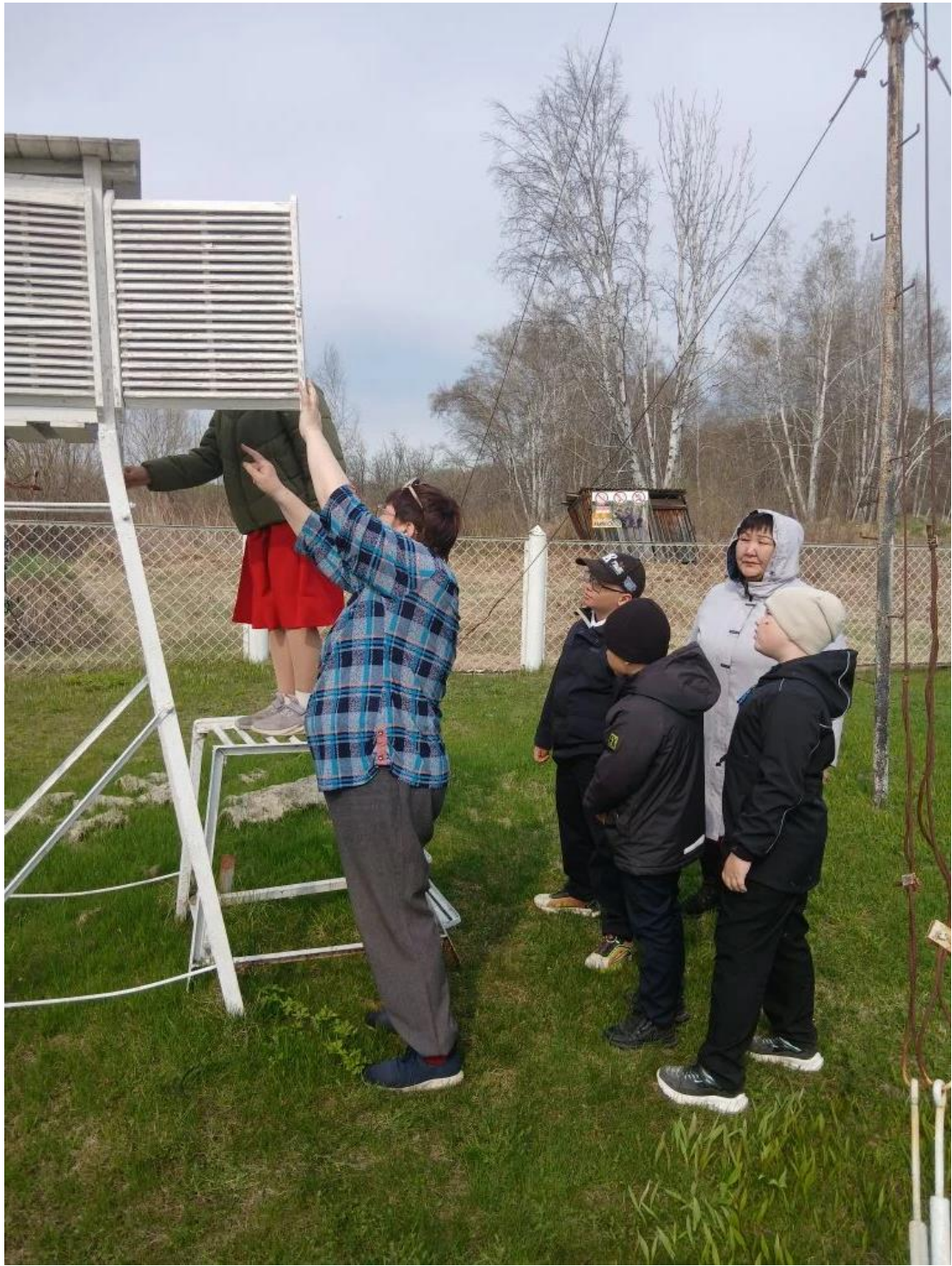
Производство наблюдений за температурой и влажностью воздуха
