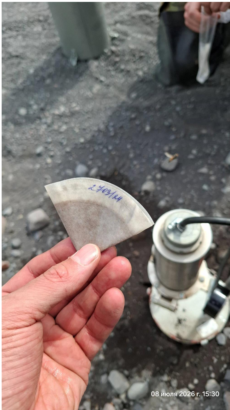
Фото 9. Определение мутности пробы воды «сухой реки» с помощью фильтровального прибора Куприна
