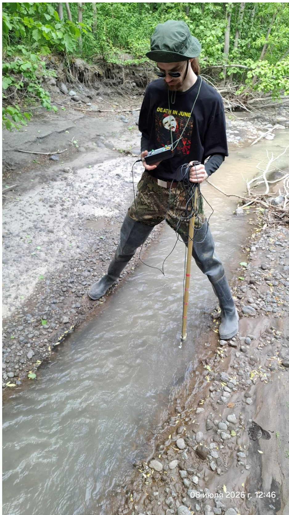
Фото 5. Измерение расхода водного потока «сухой реки» в створе русла.
