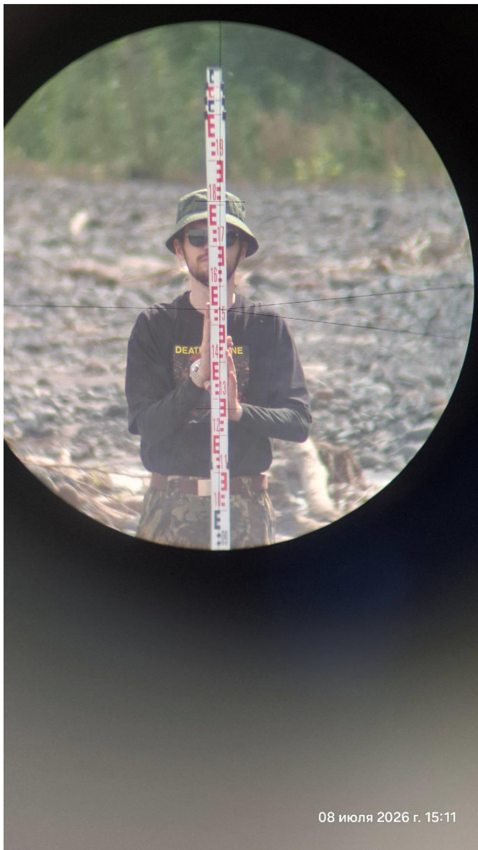
Фото 8. Измерение мгновенного уклона водной поверхности «сухой реки».
