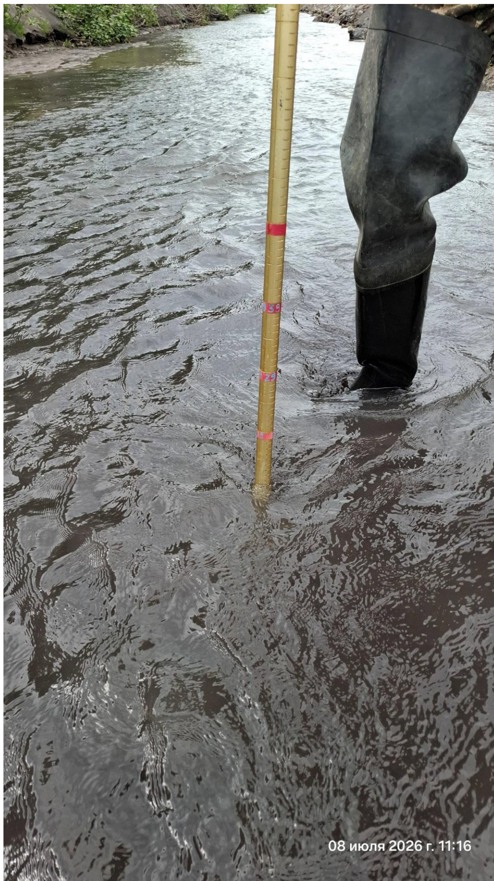
Фото 7. Измерение глубины водного потока «сухой реки» на промерной вертикали временного створа.
