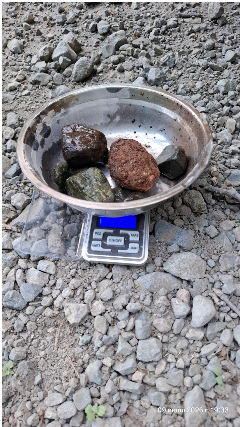
Фото 10. Определение массы пробы донных отложений при анализе гранулометрического состава
