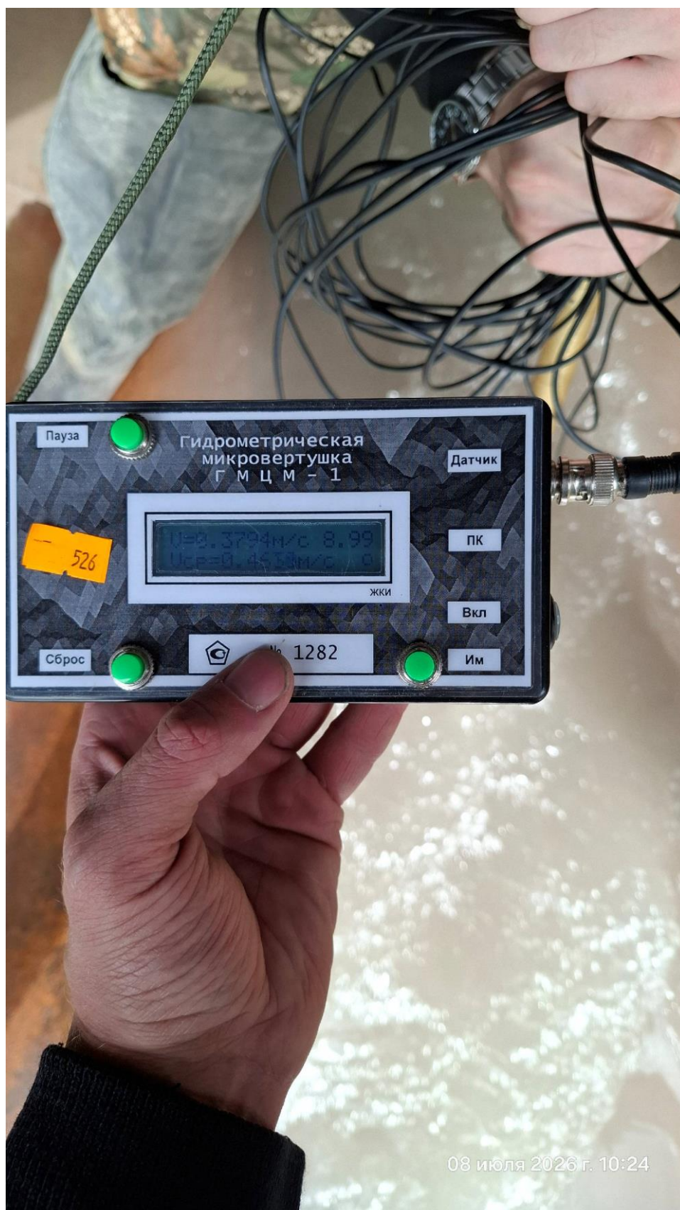
Фото 6. Измерение скорости водного потока «сухой реки» на скоростной вертикали
